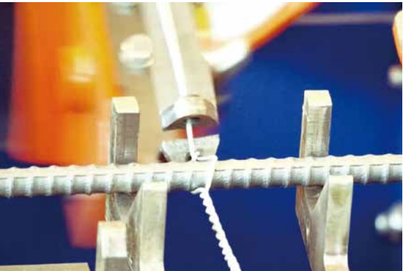
番線で鉄筋を編み込みます
